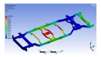
Fig. 4.12. Deformation Analysis for Epoxy
